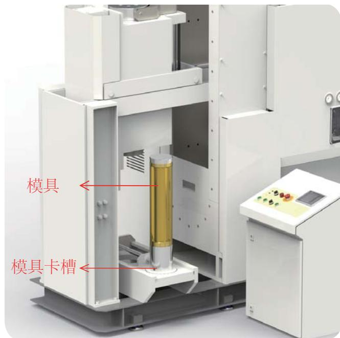
该系列设备设计有内装料和外装料两种装料方式。通常模具直径在 100mm 以内时采用外装料形式，如左图所示。模具直径在 100mm 以上时，考虑到模具总重量较大，采用内装料形式，取料时自动脱模。
